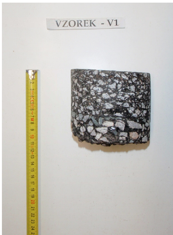
Obr. 2 - Jádro vývrtu Vzorek – V1 (laboratoř).
